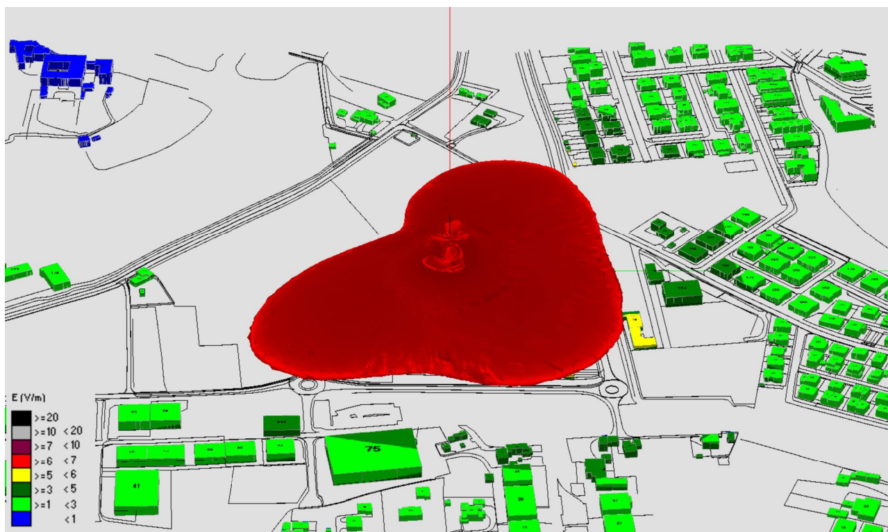
Fig. 57 Impatto elettromagnetico - Zona Depuratore Comunale - 0° N
