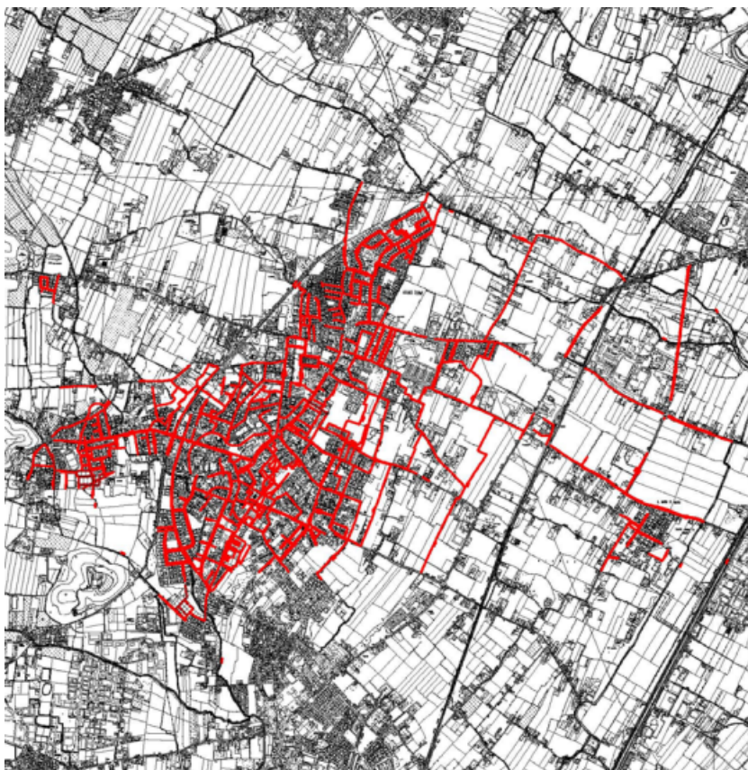
Figura 21 Servizio fognatura rete acque bianche (Fonte: U.T.C. Comune Abano Terme)
